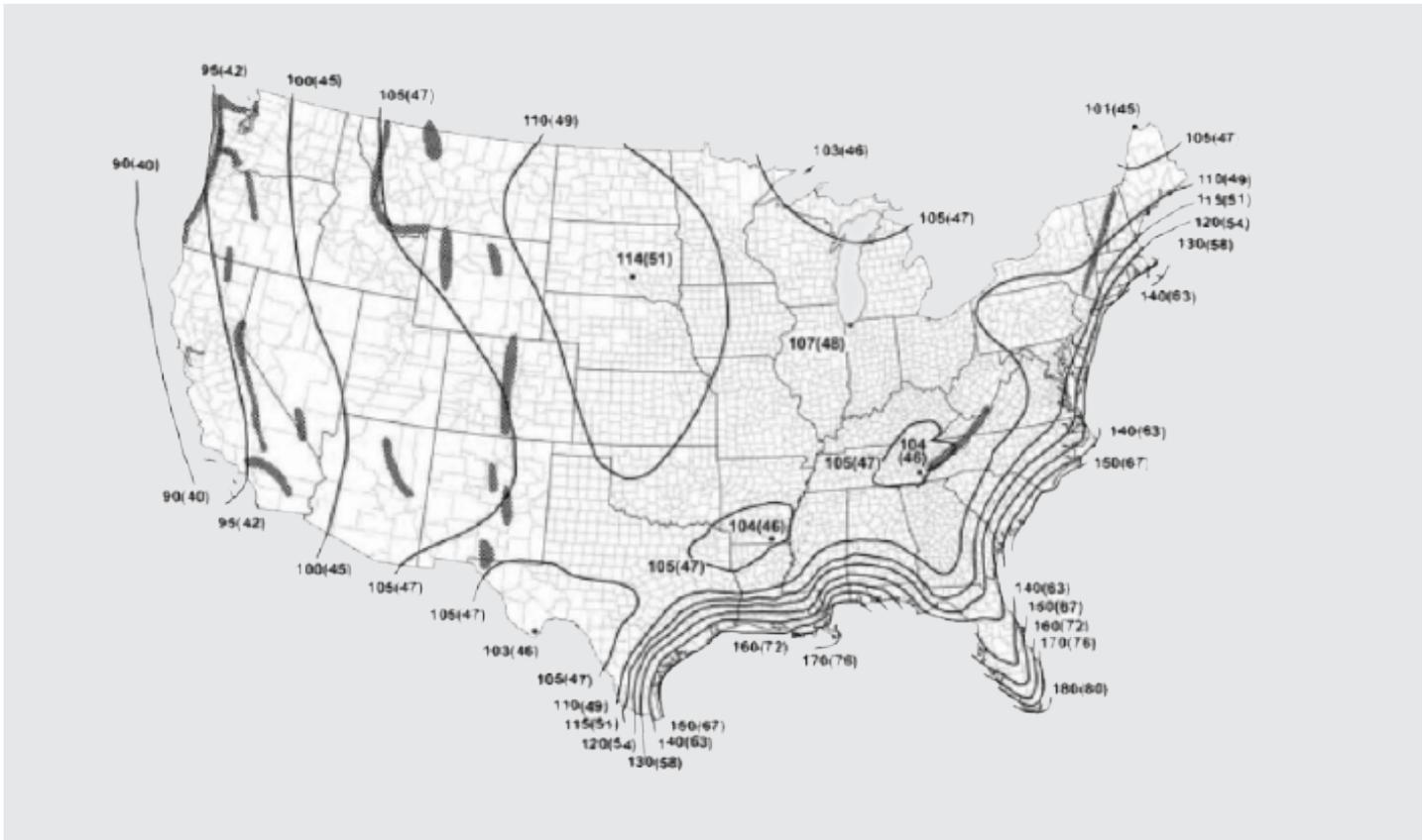
Figure 3. Vitesse de base du vent - ASCE 7-16 - Exposition C - Catégorie II
